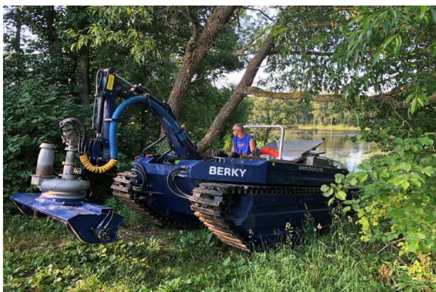
1.11. attēls. Amfībijas tipa transportlīdzeklis sapropēja ieguvei (ilustratīvs attēls)
