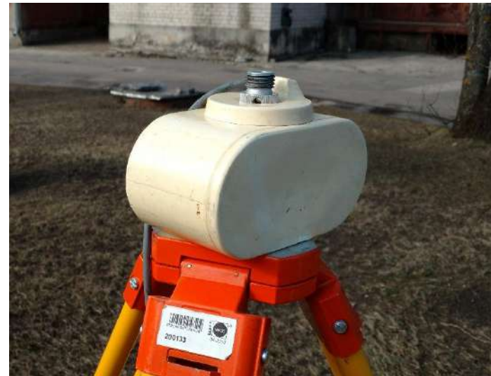
Protonu precijas magnetometrs PMP-5 kopējās lauka intensitātes mērījumiem
